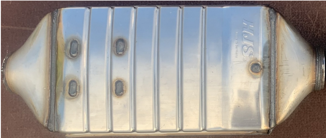
HJS partikelfilter DPF-05 til Mercedes. Flowretning fra venstre mod højre (se pil på filteret)
