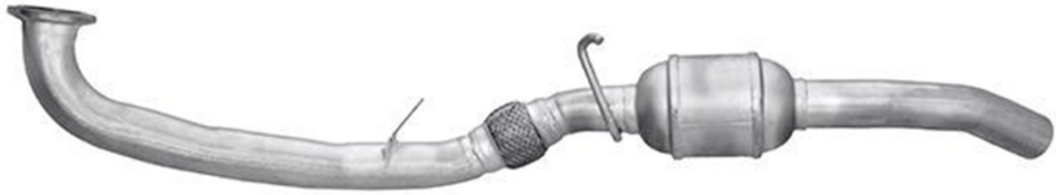
Eksempel hvor forrør og katalysator (2) er samlet i 1 stykke.
