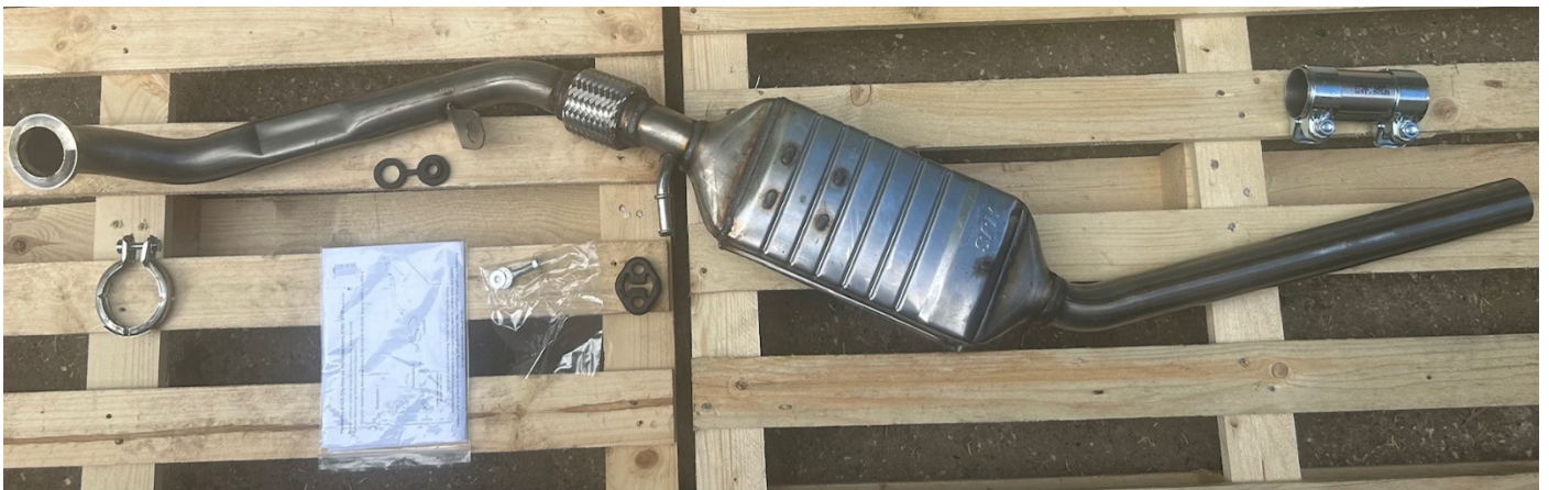
Filter DPF-05 kan leveres i flere forskelle varianter, som den viste på billedet, der er fremstillet til MB A170. Man skal ikke forvente at hele filteret passer på A180/200 og B180/200, så det skal skæres til at monteres på bilen vha. skære/svejse/muffe.
